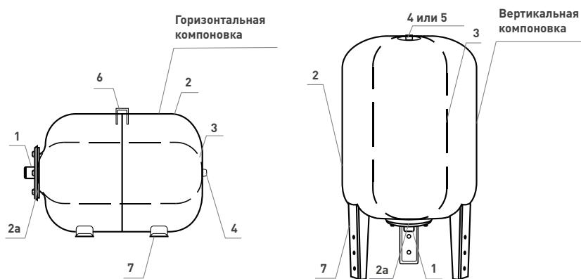
В исходном состоянии в гидроаккумулятор со стороны воздушного клапана закачан воздух до давления 1,5-2 атм. В рабочем состоянии со стороны штуцера фланца в мембрану гидроаккумулятора под давлением поступает вода, сжимая воздух, который в свою очередь выталкивает воду из мембраны при выключенном насосе и открытом водоразборном кране.
